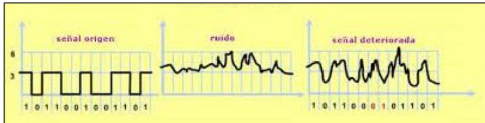
Fig. 9. Efectos del ruido en la señal
