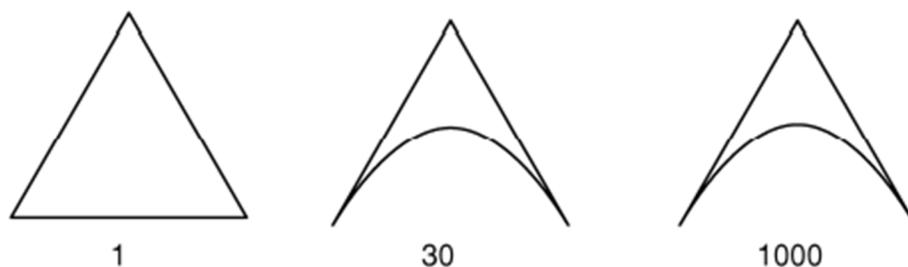
**Figura 2.13** *Jacobian Ratio* para triángulos
