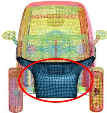
Fig. 2. Elementos finitos de la parte frontal del vehículo
