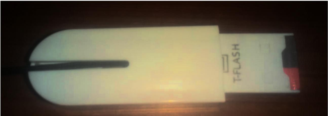
Figura 8.30: Inserción del microSD requerido para la instalación de un Sistema Operativo en el Raspberry Pi.
