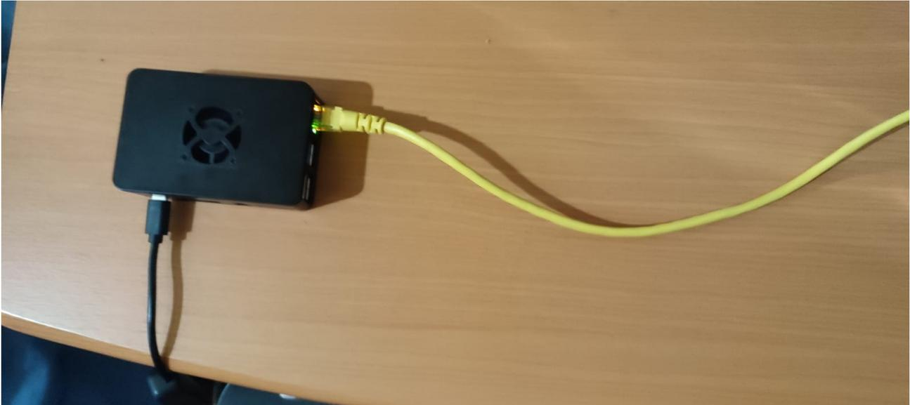
Figura 8.36: Conexión del Raspberry Pi a una red LAN.
