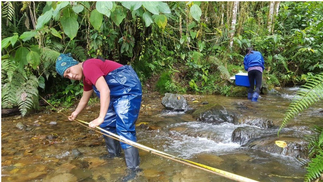
Fotografía 4. Aforo en la microcuenca del Río Itambi
