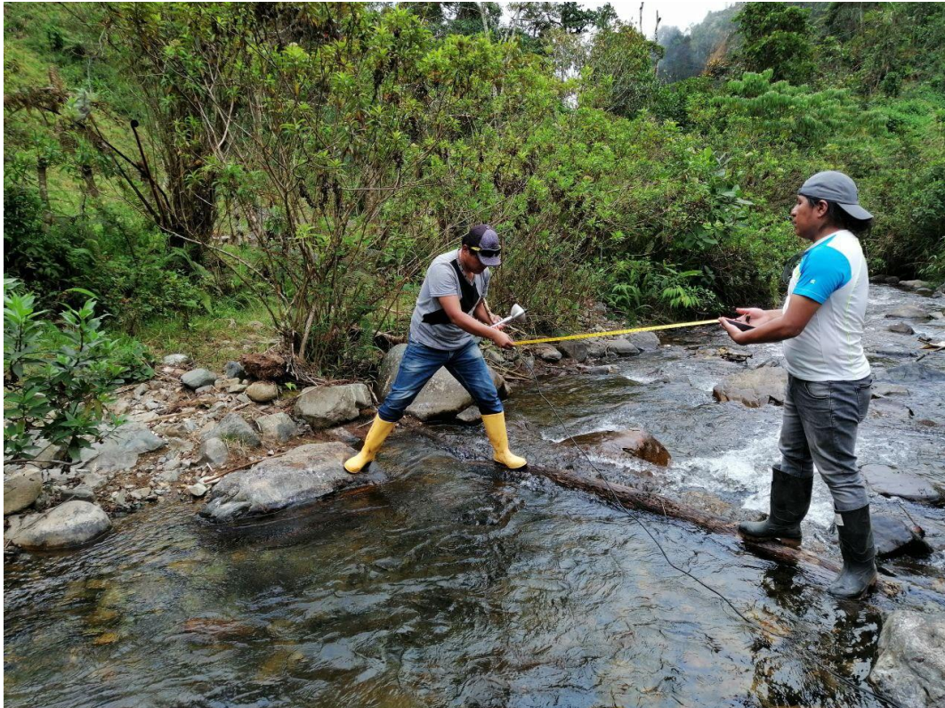
Fotografía 4. Aforo en la microcuenca del Río Itambi
