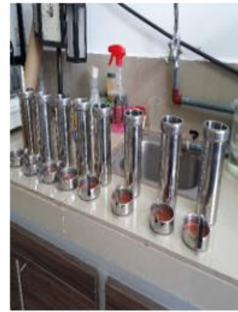
C. Colocar las muestras en los vasos de la máquina autoclave
