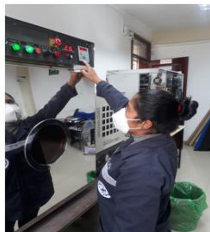
B. Programar la temperatura y el tiempo autoclave
