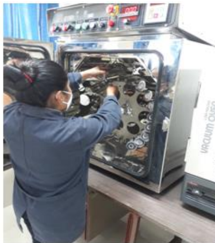
A. Colocar los vaso en la máquina autoclave
