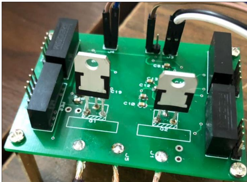
Fig. 42 PCB del inversor. Elaborado por: Autor.
