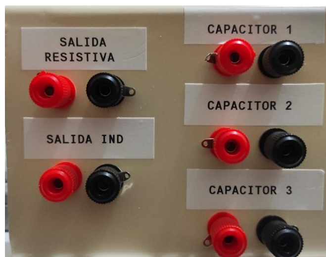
Figura 11. Bornera de conexión Fuente: Autor
