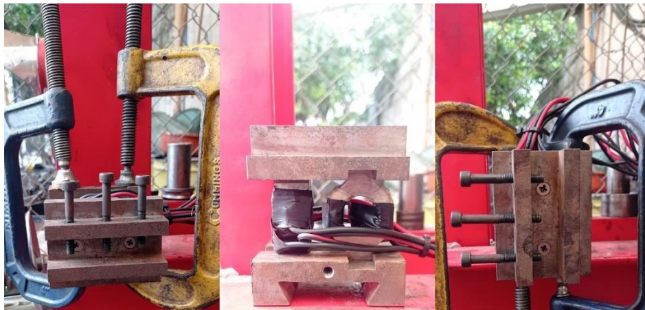
Figura 50: a) Orientación fuerza x b) Orientación fuerza y c) Orientación fuerza z
