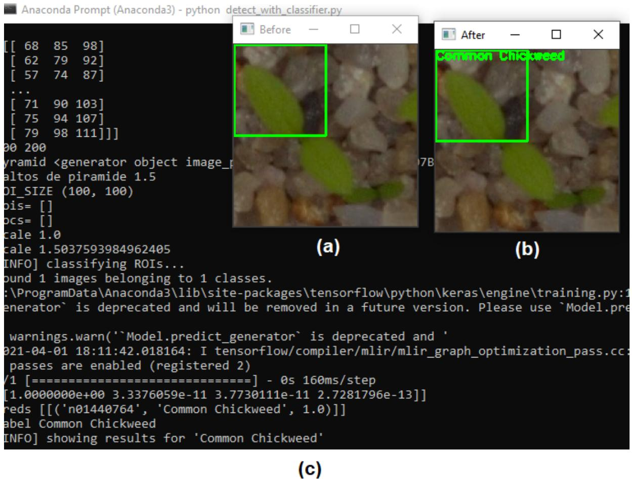
Figura 2.16: Resultados del algoritmo detector de objetos. a) Ventana con la imagen de entrada y una ventana deslizante. b) Ventana con la imagen de salida, una ventana deslizante y la etiqueta correspondiente al objeto. c) Ventana de Anaconda Prompt en la cual se ejecuta el código y se visualizan resultados.
