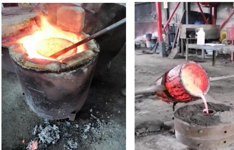
*Figura 5.11. Fundición y colado del material para las bolas.*
