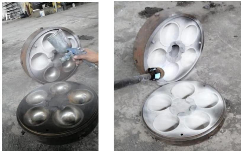
*Figura 5.10. Preparación del molde con pintura refractaria.*
