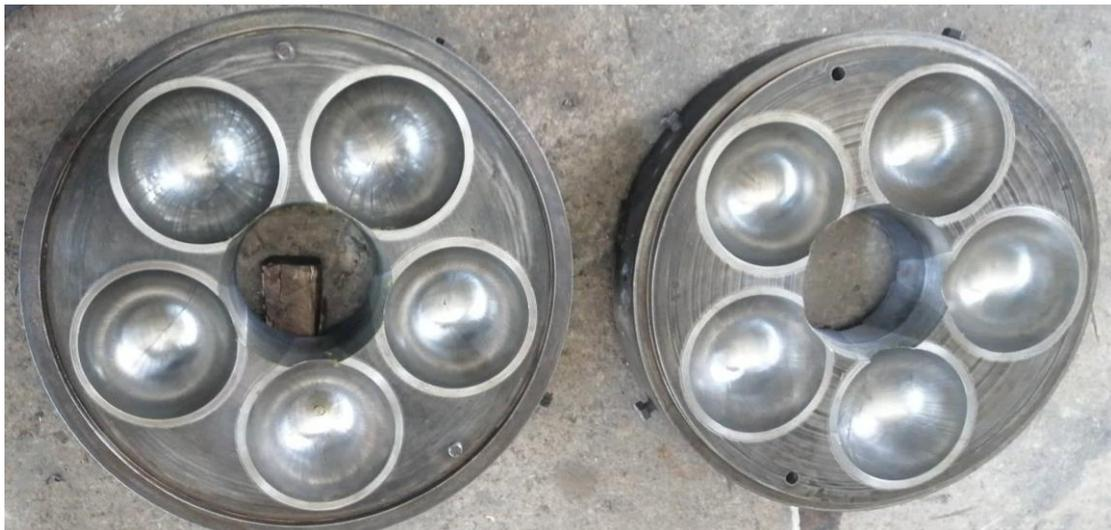
*Figura 4.23. Tapa superior(derecha) e inferior(izquierda) del molde de fundición ensamblado con los núcleos.*
