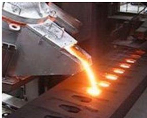
*Figura 2.7. Fundición por gravedad [16].*
