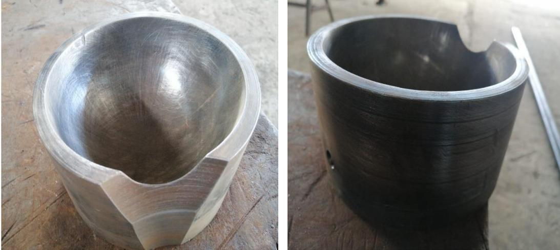
*Figura 4.21. Resultado final del mecanizado de las cavidades de fundición.*
