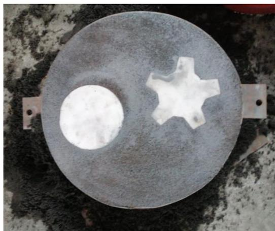
*Figura 4.26. Moldeo en arena para las piezas del patrón de bolas de fundición*
