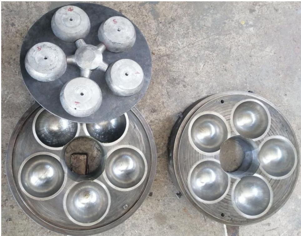
*Figura 4.28. Molde para 5 bolas de 5 pulgadas*
