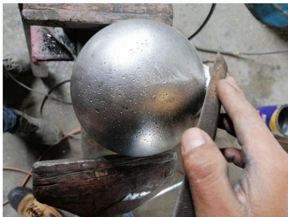
*Figura 5.13. Limado de la zona de contacto con el alimentador del molde.*
