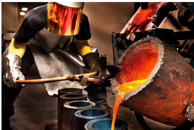
*Figura 2.3. Fundición en molde permanente [12]*
