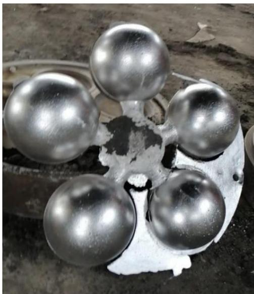
*Figura 5.12. Desmoldeo de las bolas de fundición.*
