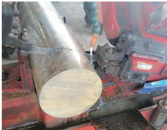
*Figura 4.20. Corte en secciones del eje de acero 1018.*
