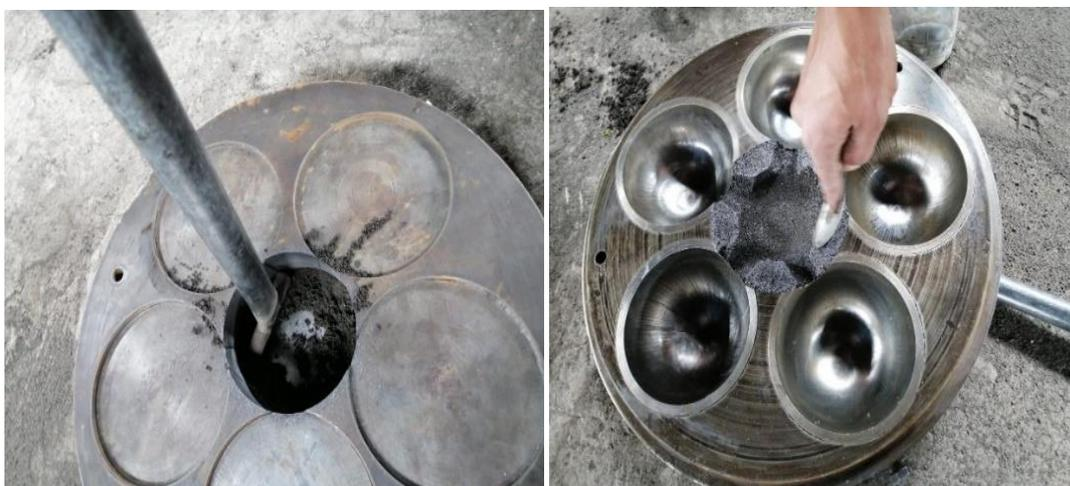
*Figura 5.9* Canales para el desplazamiento del material de fundición.
