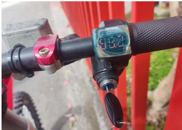
Figura 4.55: Lectura de voltaje mínimo en batería eléctrica
