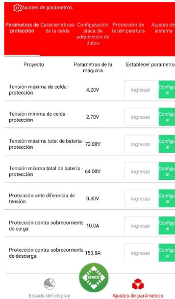
Figura 4.45: Configuración de voltaje y corriente en BMS
