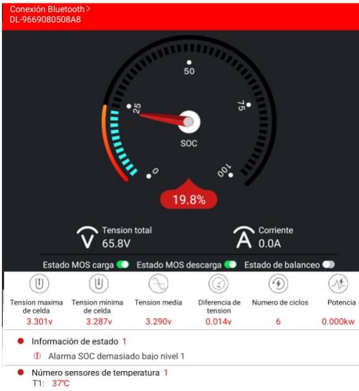
Figura 4.60: Voltaje mínimo en prueba B
