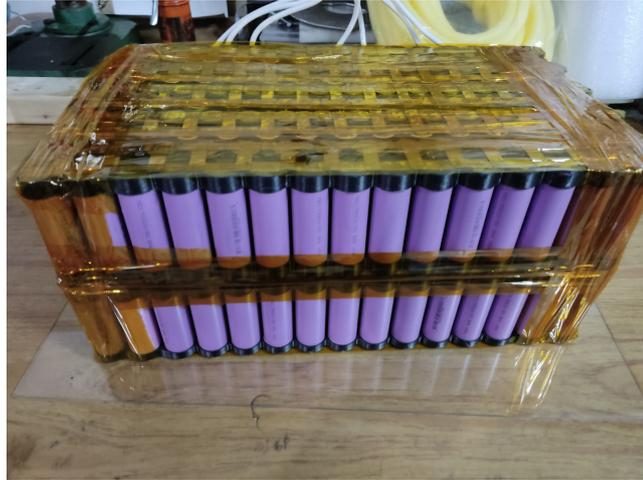
Figura 4.25: Batería eléctrica de 72V y 75Ah
