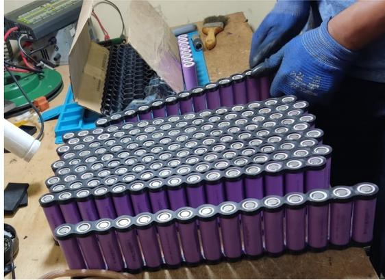
Figura 4.27: Armado de batería con separadores
