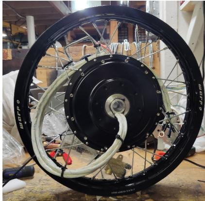
Figura 2.17: Motor eléctrico Enertrac MHM-603
