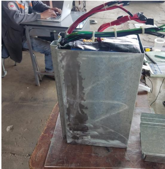
Figura 4.32: Carcasa metálica para batería eléctrica
