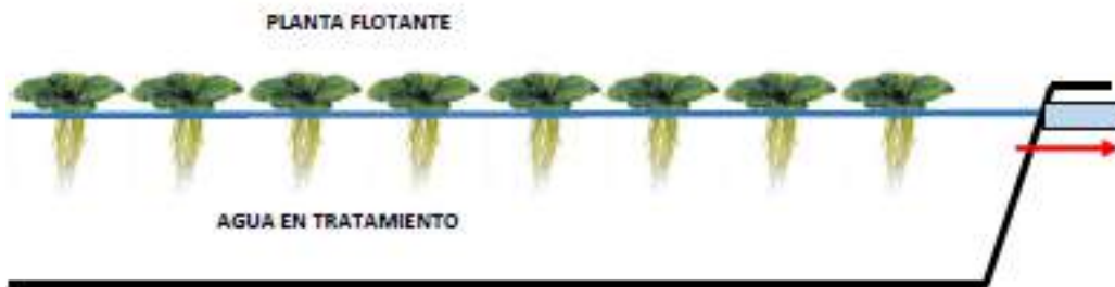
Figura 4.34. Esquema humedal con plantas flotantes
