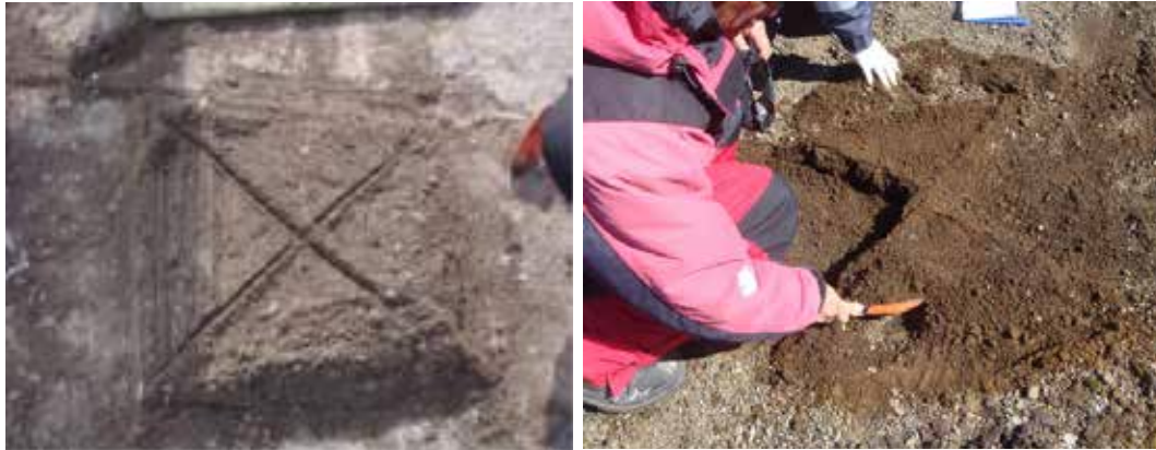
Figura 2.8. Toma de muestras por cuarteo a) muestra previa, b) toma de muestra según la metodología
