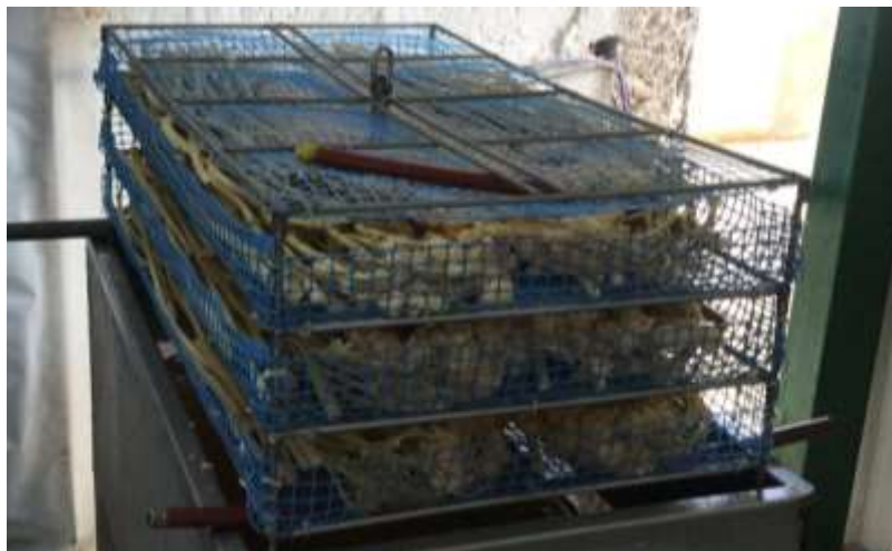
Figura 8: Armado de Rejillas para el proceso de deshidratación
