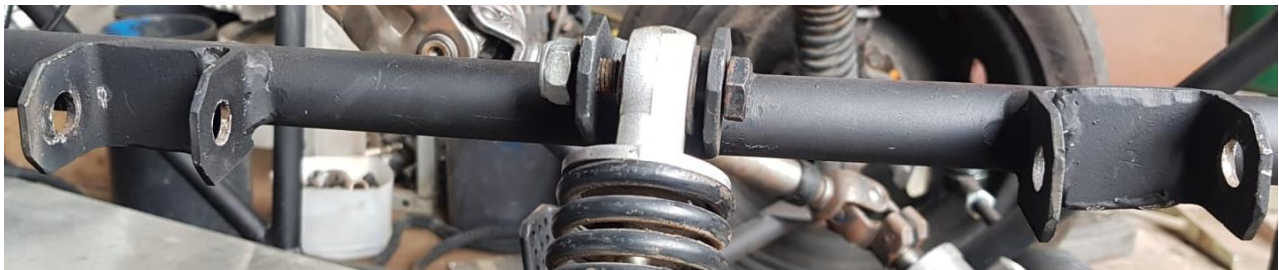
Figura 2.16 Punto de unión mesa – bastidor
