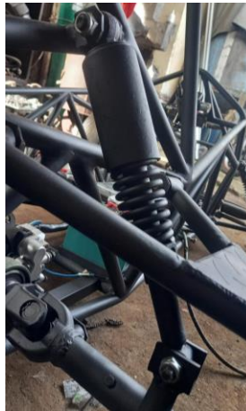
Figura 2.17 Instalación de monoshock
