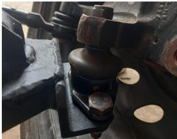
Figura 2.14 Punto de unión con la mangueta
