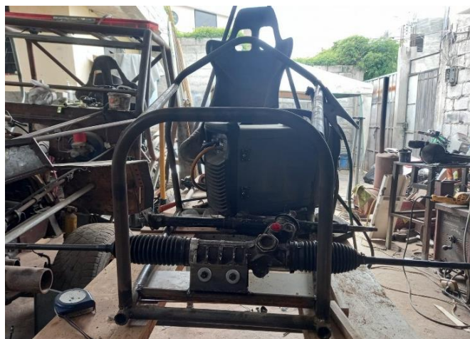
Figura 2.23 Instalación de la cremallera en el bastidor
