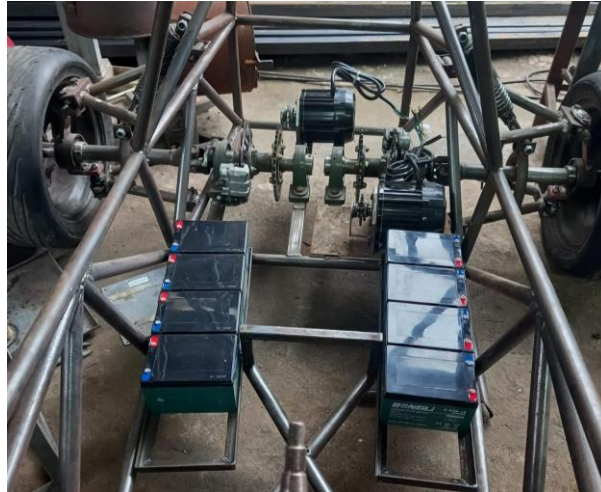
Figura 2.32 Ubicación baterías y motores eléctricos
