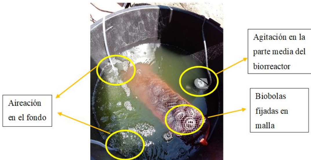
Figura 7. Biorreactor de crecimiento de bacterias degradadoras de \text{NH}_4 y \text{PO}_4 . En la figura se expone la distribución de aire en el agua bioestimulada, generando dos posibles zonas (anóxica y aeróbica)
