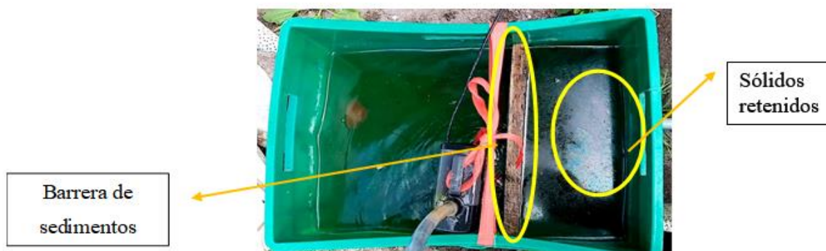
Figura 12. Sedimentador 2. La barrera de sedimentos logró retener las partículas presentes, luego el agua fue distribuida al tanque inicial
