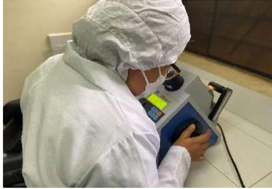
**Figura 13.** Medición de °Brix
