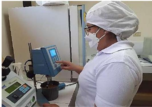
**Figura 14.** Medición viscosidad
