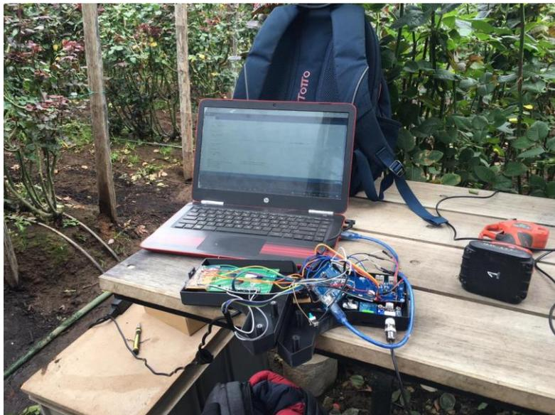
*Nota.* En la imagen se visualiza el proceso de calibración del hardware de manera manual y el enlace mediante USB para la calibración por software.
