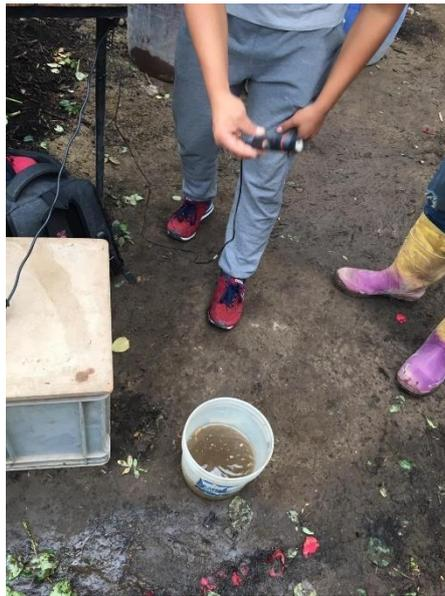
*Nota.* En la imagen se realiza la medición del pH del agua mediante el procedimiento de disolución en agua que se solía realizar mediante papeles de pH.
