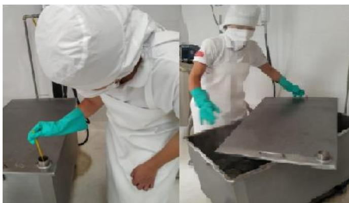
**Sellado.** Pasado los 20 minutos del tratamiento térmico, se procedió a retirar cada una de las latas del equipo, con precaución de que en ningún momento se levante la tapa, ya que se perdería el vacío que se creó en los procesos realizados anteriormente. Se pasó a una enlatadora
