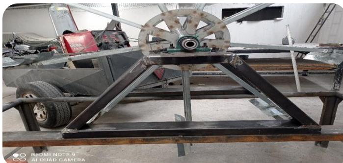
Al armar cada componente de la bomba se realiza la colocación de 50m de manguera al interior de la rueda obteniendo un total de ocho vueltas, permitiendo el transporte de fluido al lugar del destino. En la figura 13 se visualiza el prototipo de la rueda hidráulica.
