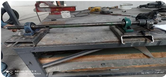
Al realizar este procedimiento permite al sistema de bombeo de agua obtener el movimiento aprovechando la energía cinética del río. Se logra realizar el acoplamiento del sello mecánico al eje.
