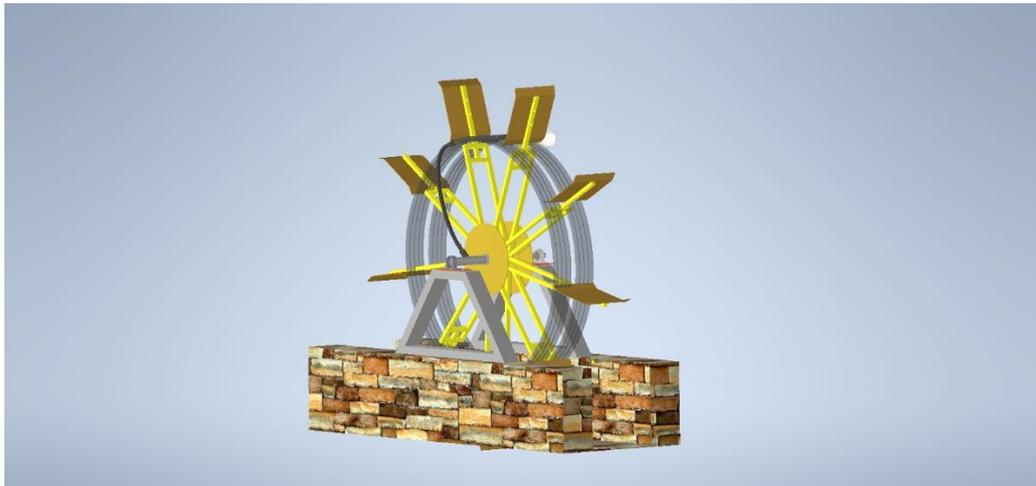
Los resultados del modelamiento son comparables por metodología realizados por Mott (2016) la rueda hidráulica deberá contar con la resistencia suficiente para resistir la fuerza del agua y la abrasión, sus componentes serán de láminas metálicas, tol para formación de los alabes, soportes y su eje de acero. Shigley & Mitchel (2014) hacen referencia al tamaño de sus materiales deben tener el menor peso posible para que sea sencilla su manipulación.
