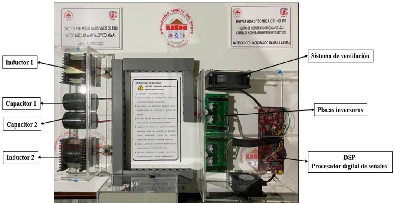
Figura 48. Inversor boost monofásico en malla abierta
