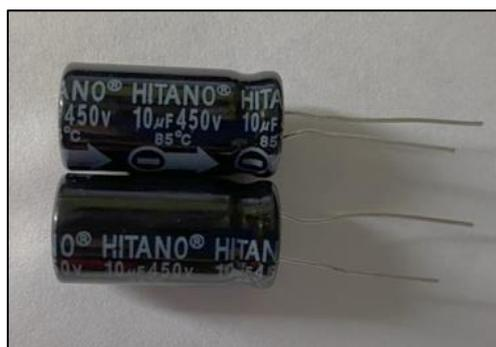
Figura 30. Capacitores seleccionados, del inversor boost.
