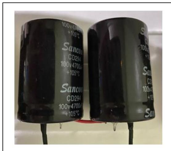
Figura 5. Capacitores electrolíticos de 4700uF
