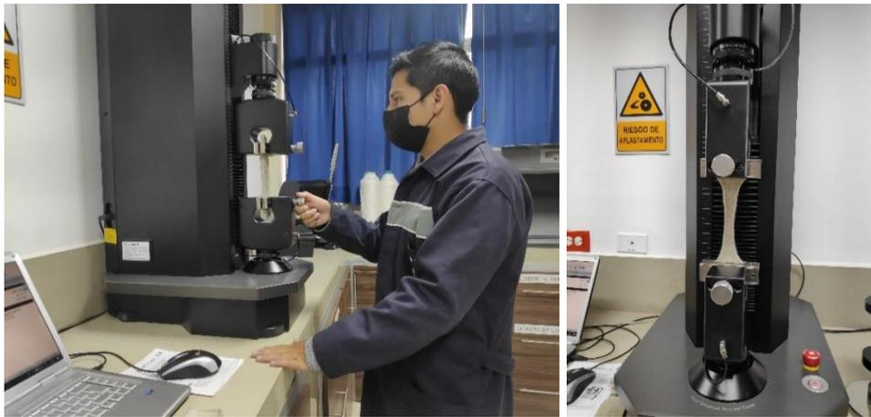
Anexo 11. Prueba de resistencia a la Tracción
