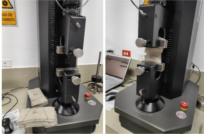
Anexo 13. Prueba de resistencia al rasgado
