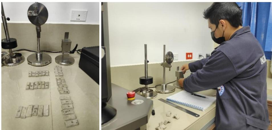
Anexo 12. Prueba de resistencia al pliegue
