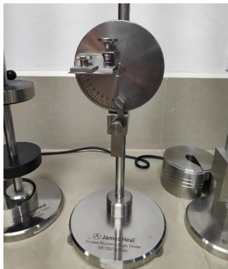
**Figura 12.** Medidor de ángulo de recuperación
