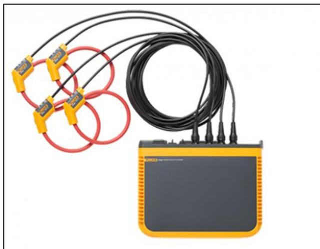
Figura. 14: Analizador de red Fluke 1748
