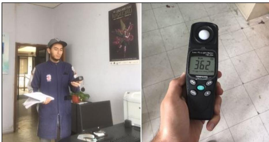
Figura. 26: Toma de datos Luxómetro
