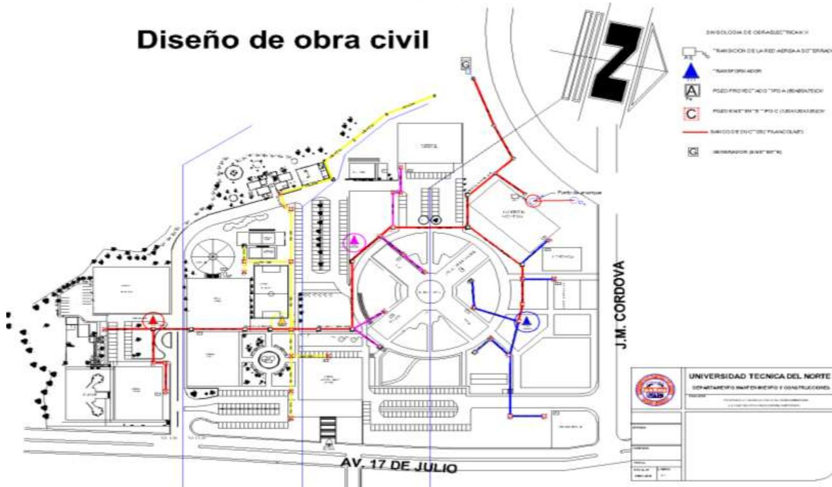
Plano 2: obra eléctrica de Medio Voltaje y la distribución de los transformadores
