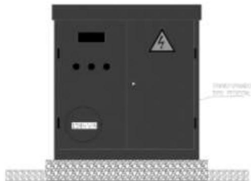
Fig.11. Transformador tipo pedestal.
