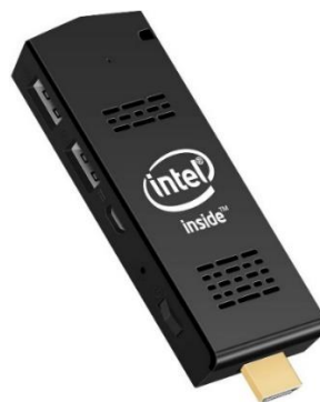
Figura 9. Miniordenador Pc stick Intel Fuente: Tomado de (Brief,2019)
