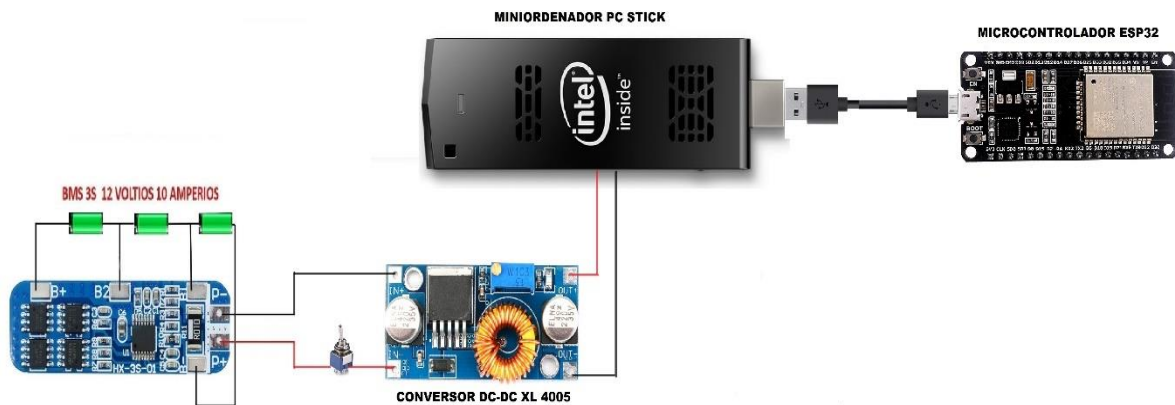
Figura 32. Diagrama de conexión miniordenador Pc stick Fuente: Elaboración Propia
