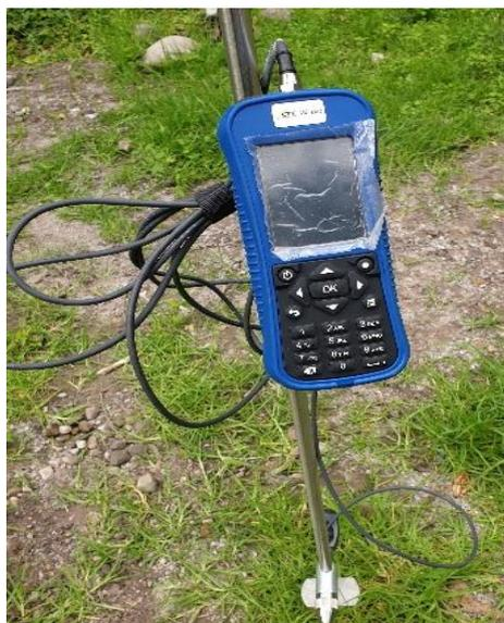
**Figura 8.** Molinete electromagnético (OTT MF Pro)
