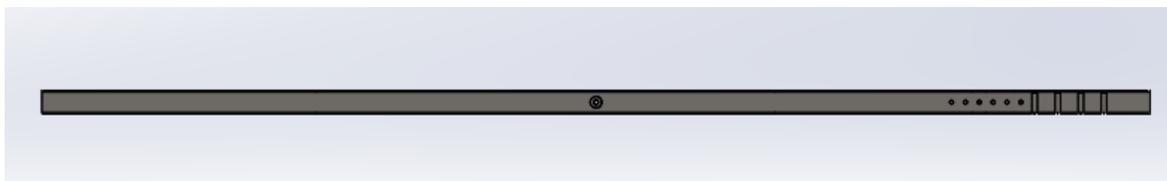
*Nota.* Este elemento está agregado al diseño según la norma *NTE INEN 2415*, con medidas de fabricación 50mm x 50mm x 2mm en su sección transversal.
