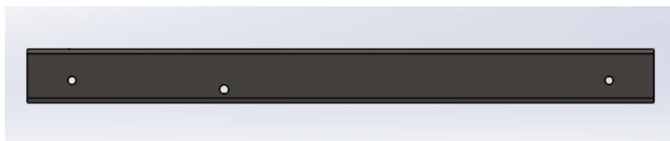
*Nota.* Este elemento está agregado al diseño según la norma *NTE INEN 2415*, con medidas de fabricación 40mm x 60mm x 1,5mm en su sección transversal.
