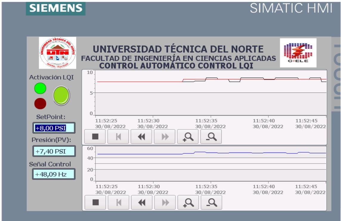
Fig. 61 Funcionamiento del controlador LQI después de llegar al punto de operación
