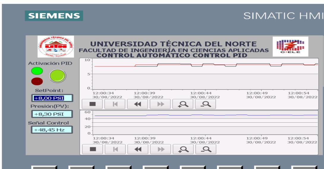
Fig. 57 Funcionamiento del controlador PID después del punto de operación
