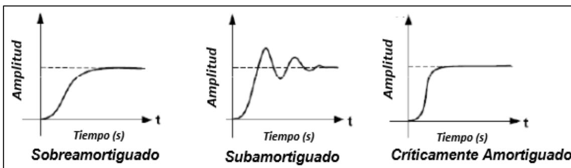
Fig. 12. Respuestas de un sistema de segundo orden.
