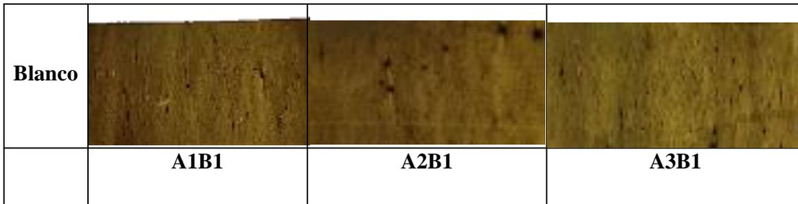
**Figura 15.** Imágenes de las películas de plástico después de 52 días de degradación biológica en un biorreactor batch. 1, 2 y 3 corresponde a las repeticiones realizadas
