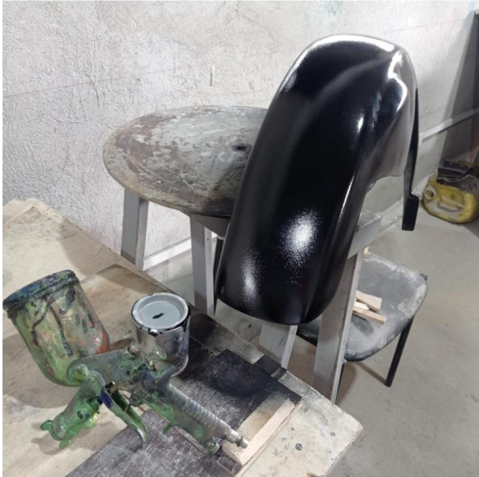
Figura VII.1 Proceso de pintura del guardafango
