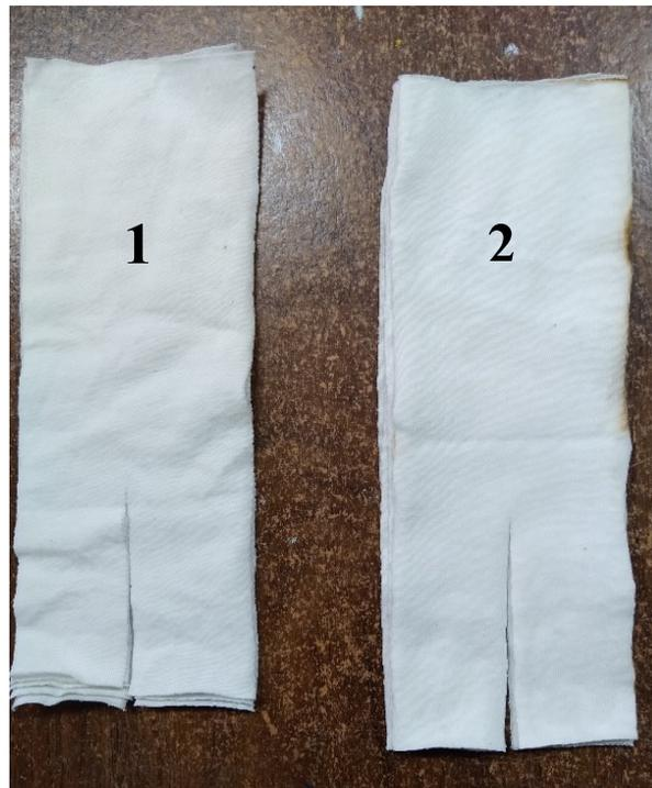
*Nota:* La figura que la muestra 1 se encuentra sin aplicación de plasma, y muestra 2 con aplicación de plasma
