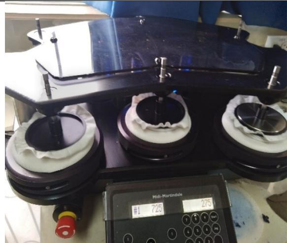
D. Proceso de resistencia al pilling en el equipo.
