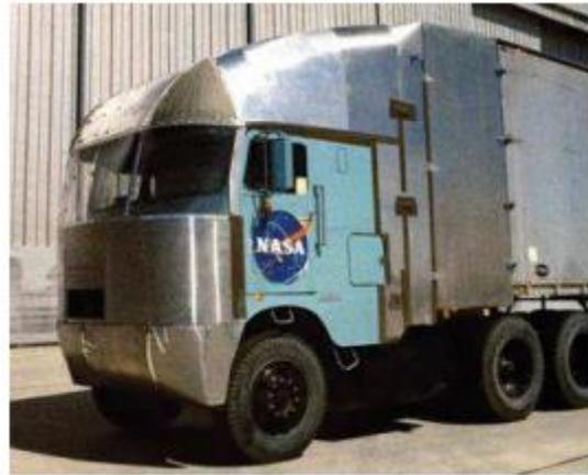
**Figura 2.2** Prototipo de primer modelo de deflector
