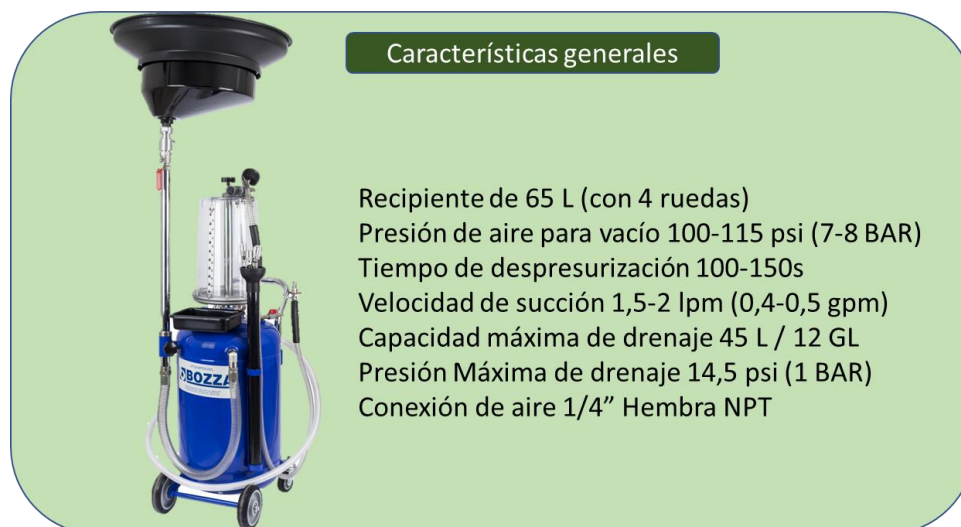
Gráfico 30. Colector presurizado de aceite Fuente: Adaptado de Bozza (2022d)
