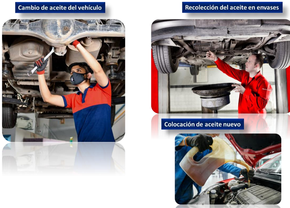
Gráfico 23. Proceso de cambio de aceite en el vehículo Fuente: Elaboración propia
