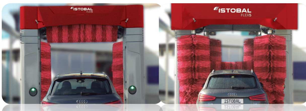
Gráfico 25. Puentes electrónicos para el lavado de autos, funcione de manera digital y programando el servicio
