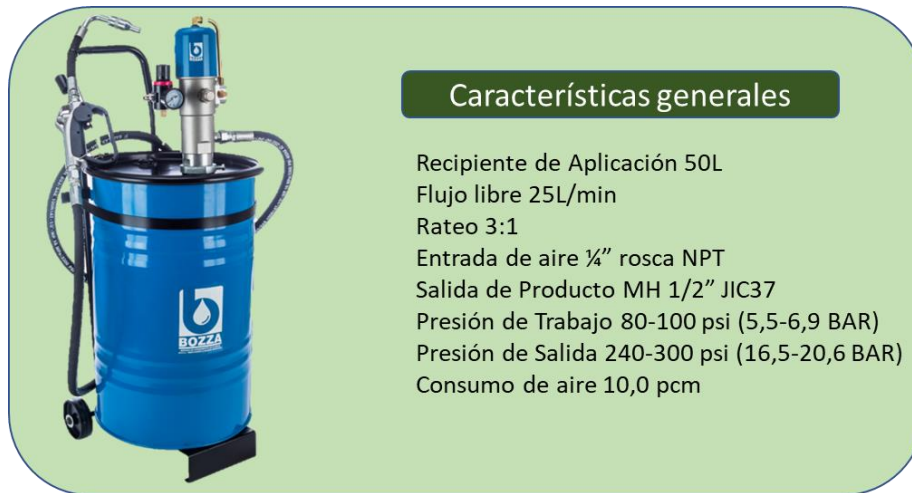
Gráfico 29. Propulsora neumática para aceite lubricante Fuente: Adaptado de Bozza (2022b)
