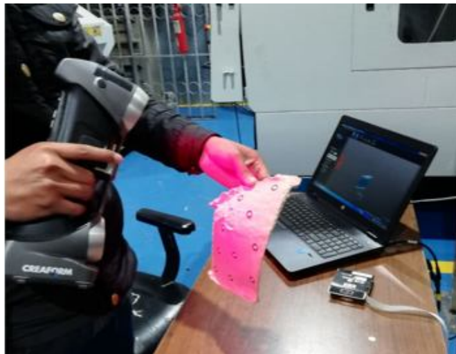
Escaneo 3D del alabe de rodete turbina tipo Francis
