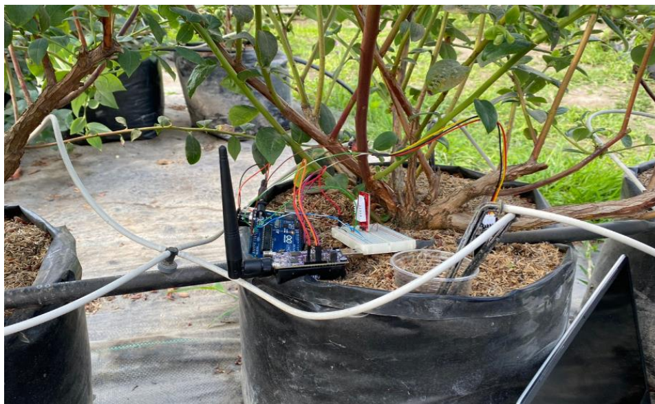
Figura 50. Nodo de Sensor 1 ubicado en la maceta.
