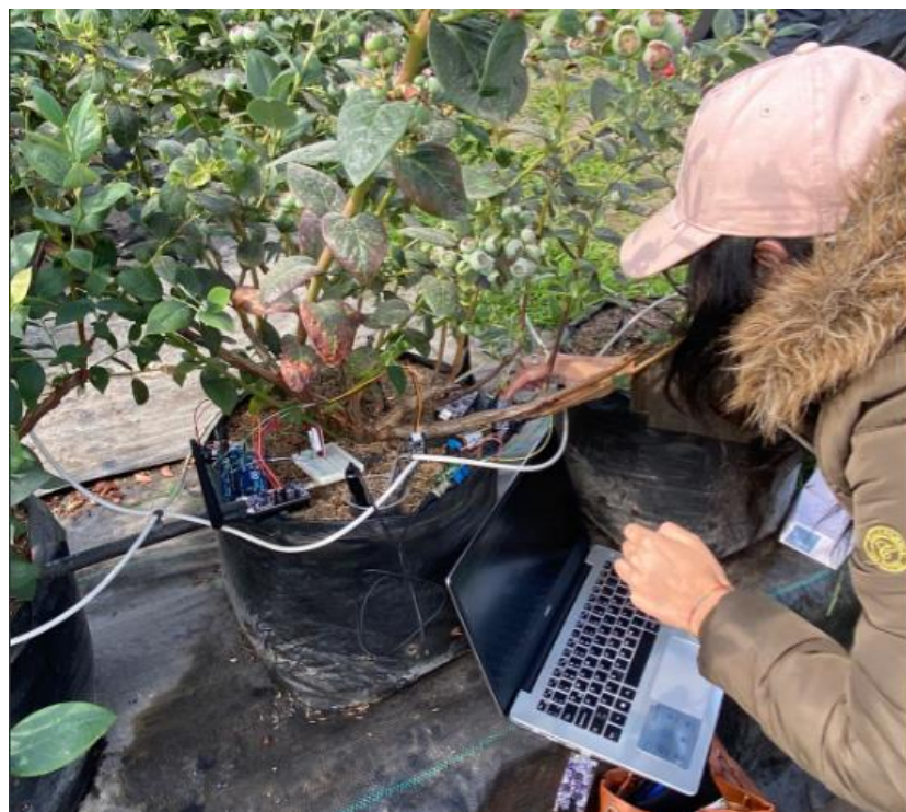
Figura 51. Nodo de Sensores 2 ubicado en la maceta.
