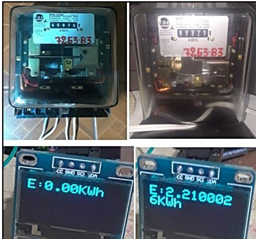
Figura 48. Medición del consumo entre el medidor y el prototipo
