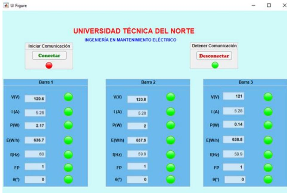
Figura 28. Comprobación de valores en HMI
