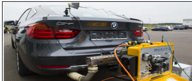
Figura 1.8 Vehículo equipado con dispositivo PEMS (Soria, 2017)
