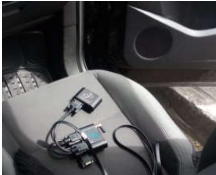
Figura A I.2 Conexión del Registrador de Datos CAN Edge y el módulo CANmod GPS en el conector OBD II del vehículo Ford Escape 2013
