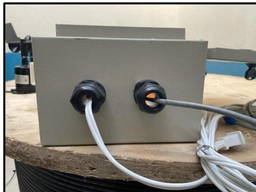
Para prever una desconexión debido a falta de alimentación de energía eléctrica en la estación meteorológica, se implementa un dispositivo UPS CDP R-UPR508 interactivo con regulador 500W - 240W con 8 tomas como se ilustra en la Figura 3.23, este se alimenta de
