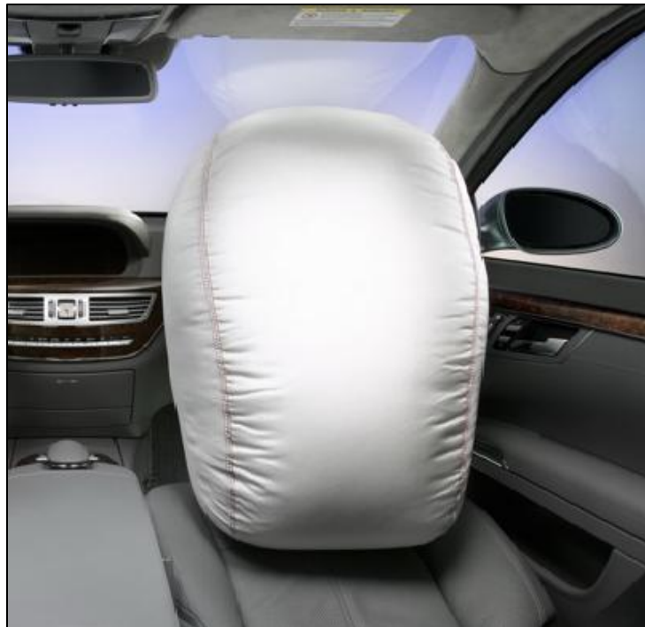
Figura 3 Airbag acompañante ( VIZCAINO, 2014 )
