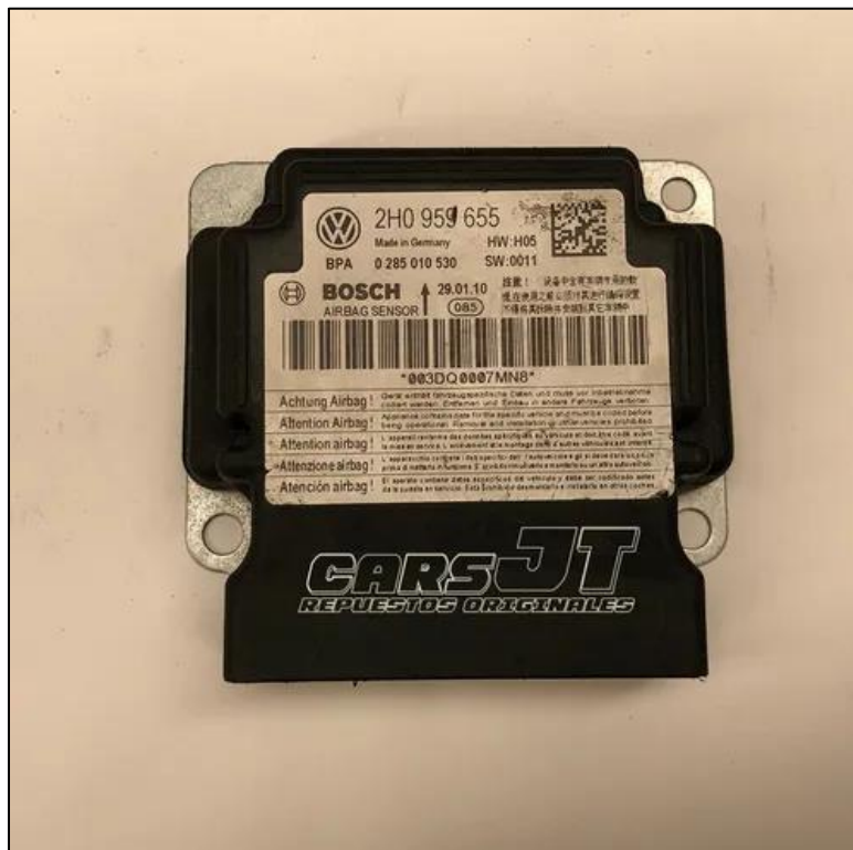
Figura 5 Modulo del Airbag Volkswagen Amarok (CARS JT, 2020)
