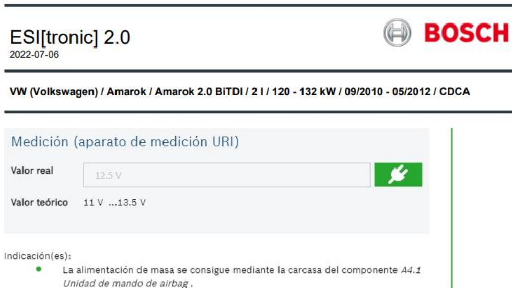
Figura 32 Comprobación de tensiones de la unidad de control.
