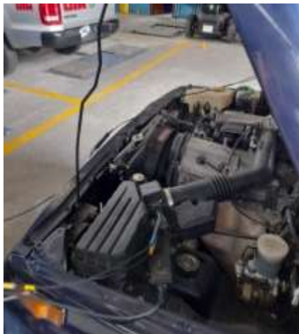
Figura 2.16 Medición de señal del sensor MAF
