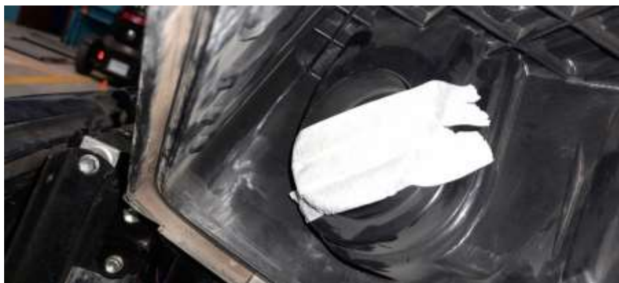
Figura 2.11 Obstrucción del sensor 50%
