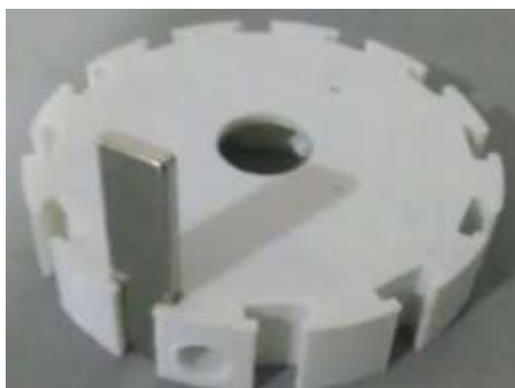
*Figura 30. Prototipo 1 de rotor*
