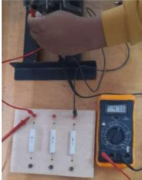
Figura 39. Prueba de voltaje en vacío Fase A en rotor de PLA magnético
