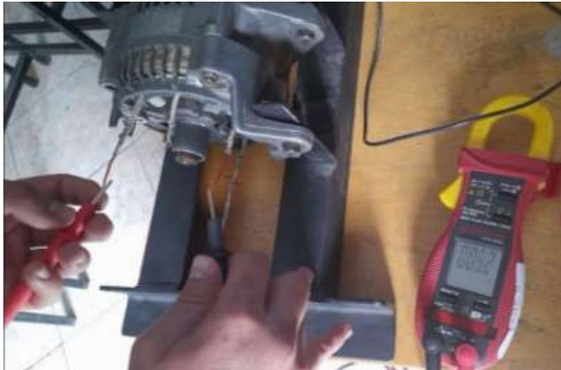
Figura 38. Voltaje en vacío Fase A en rotor de PLA
