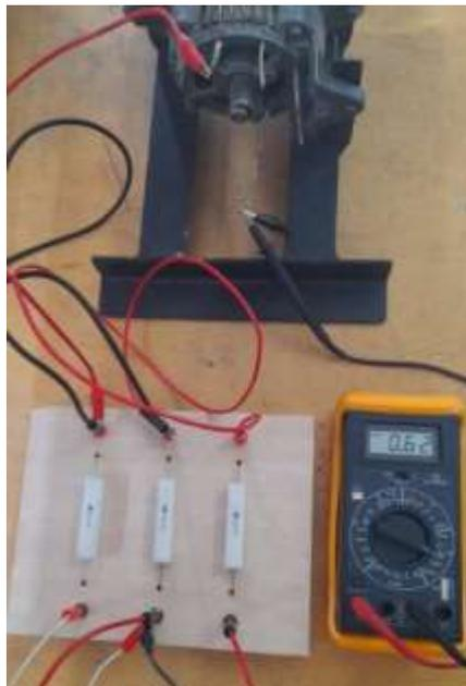
Figura 43. Prueba de corriente con cargas de 5 ohmios en paralelo
