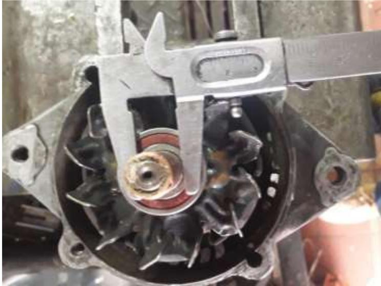
*Figura 13. Medición de diámetro interno del rotor*
