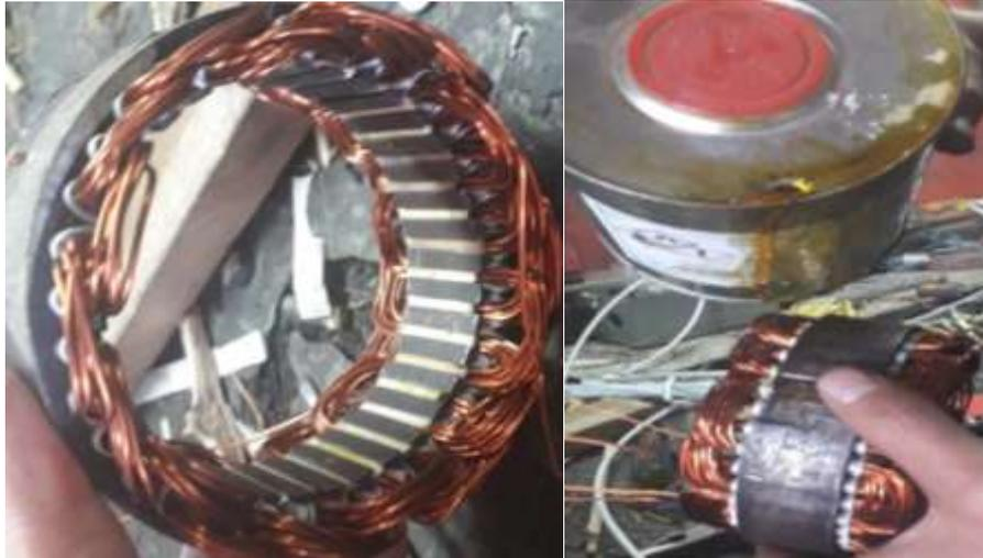
*Figura 29. Bobinado del estator*
