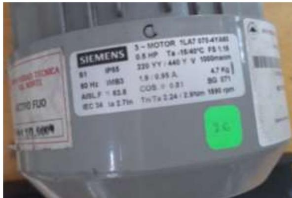
Figura 36. Placa de características de motor utilizado para pruebas
