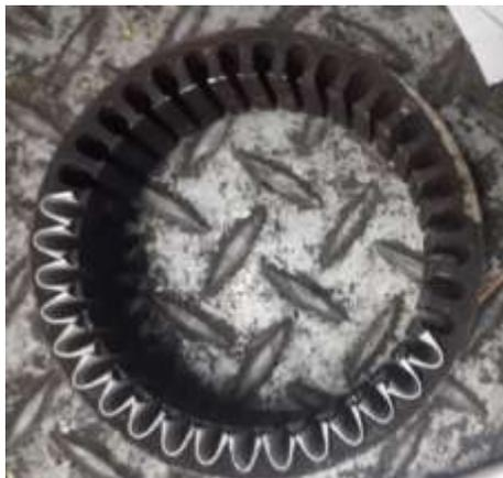
*Figura 28. Colocación de papel aislante para bobinado del estator*
