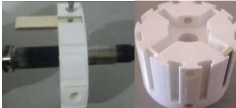
*Figura 31. Prototipo 1 de rotor con tapa de imanes*
