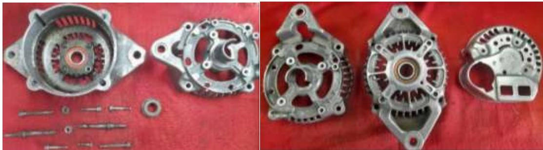
*Figura 27. Despiece de carcasa del generador*
