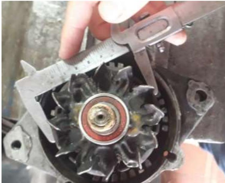
*Figura 14. Medición de diámetro externo del rotor*
