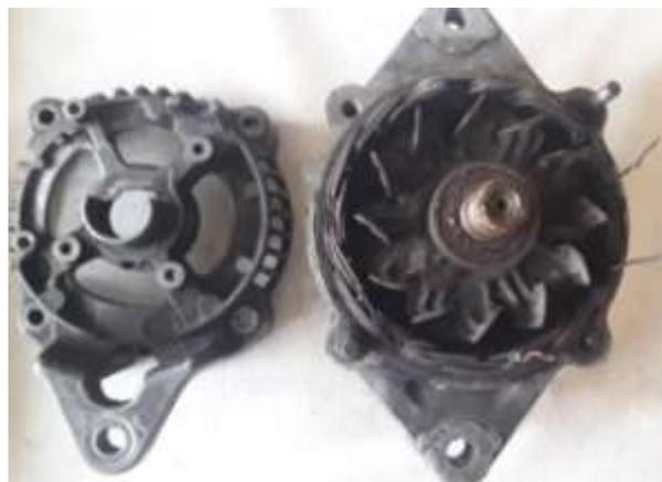
Figura 26. Extracción de carcasa superior del generador
