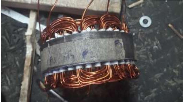
Figura 11. Estator con bobinado nuevo
