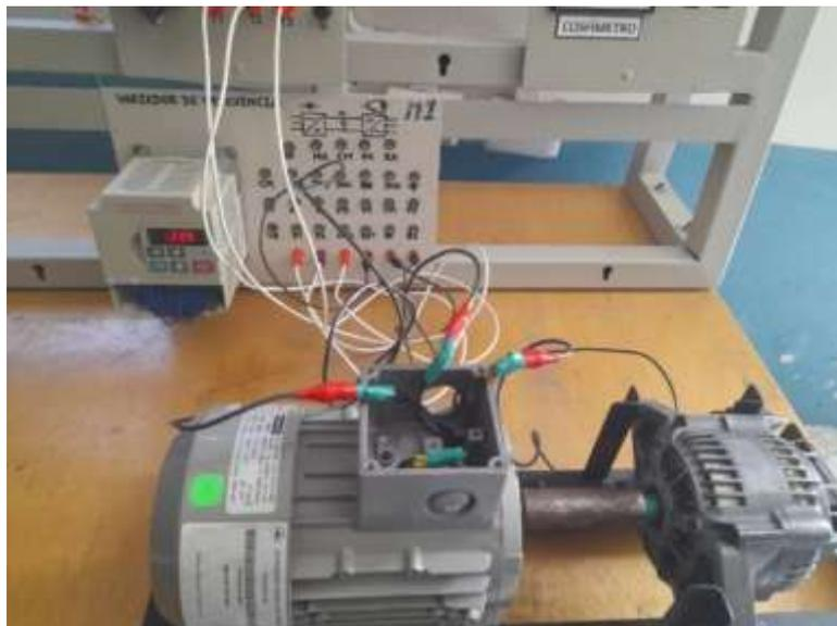
Figura 37. Banco de pruebas con generador, motor y variador de frecuencia
