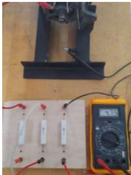
Figura 41. Prueba de corriente con cargas de 5 ohmios en serie
