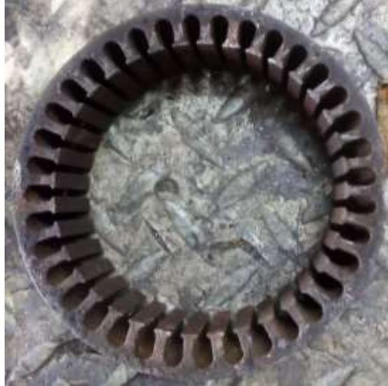
Figura 10. Estructura del estator sin bobinas
