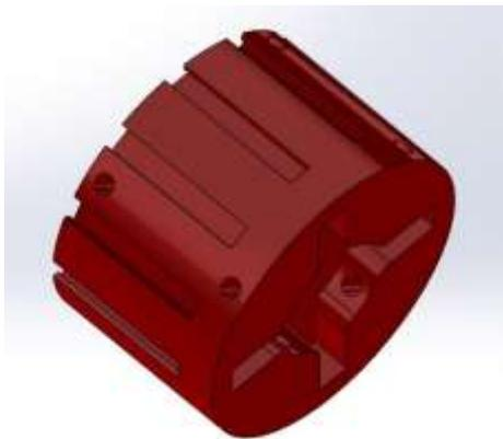
*Figura 15. Diseño de prototipo de rotor vista posterior izquierda*
