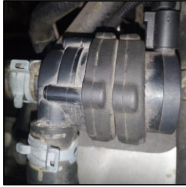
Figura 2.18 Bomba auxiliar eléctrica.
