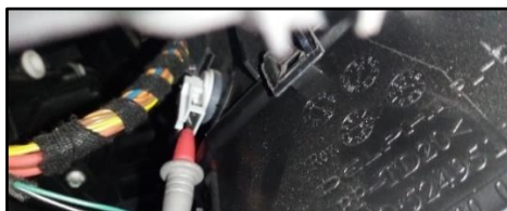
Figura 1.7 Sensor de temperatura evaporador camioneta Amarok
