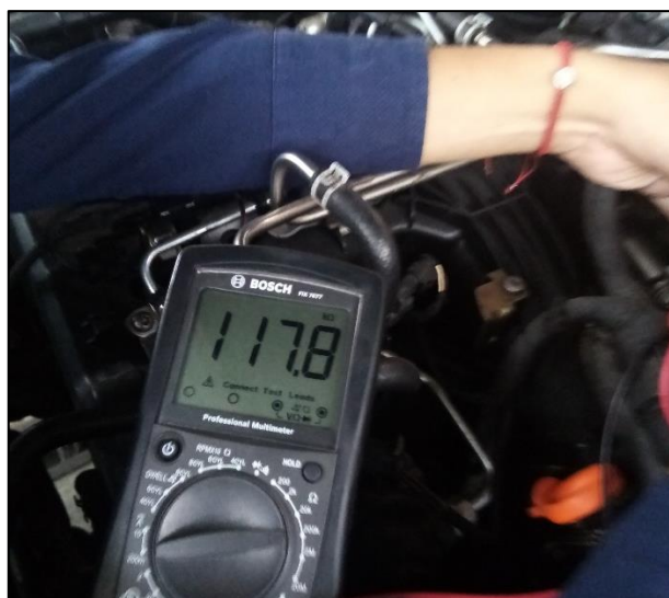
Figura AIII.2 Medición la resistencia sensor de presión A/C con multímetro 118 k \Omega
