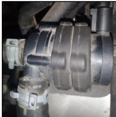
Figura 1.6 Bomba auxiliar eléctrica de la calefacción
