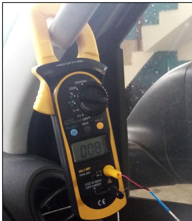
Figura AIII.3 Medición con multímetro con sensor de temperatura las ventoleras laterales y centrales prueba de frío 8°C, puertas y ventanas cerradas.
