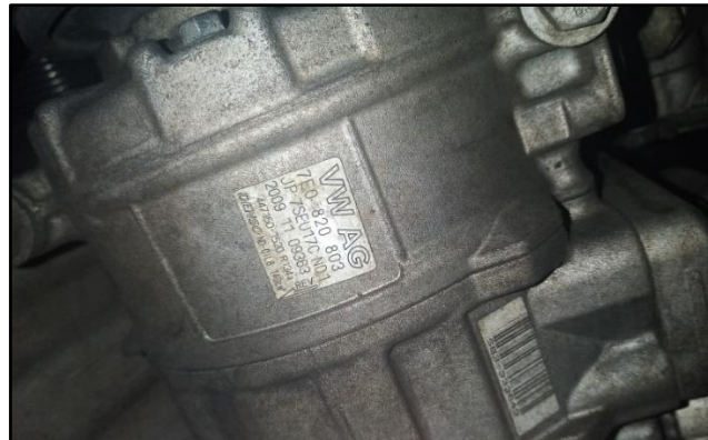
Figura 2.15 Placa de características del compresor Marca Denso.
