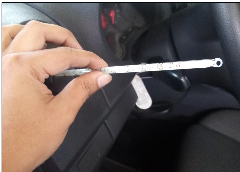
Figura AIII.4 Medición con termómetro de mercurio ventoleras centrales frío 8°C
