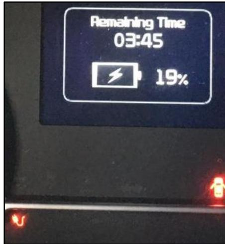
**Figura 3.16** Display de indicador de tiempo y porcentaje de carga
