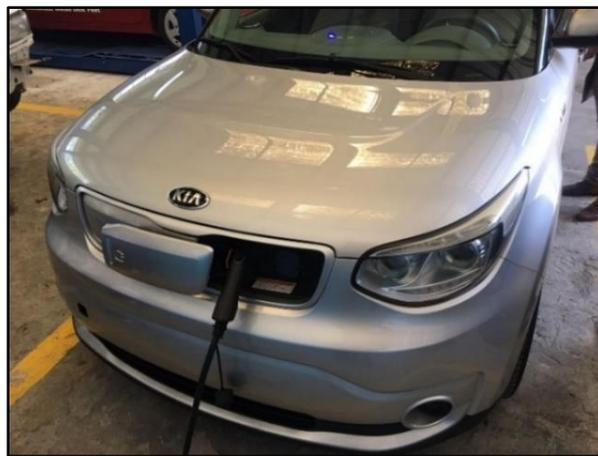
**Figura 3.15** Conexión equipo de carga y vehículo
