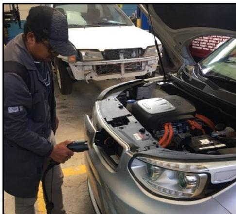
**Figura 3.17** Desconexión del conector SAE J1772
