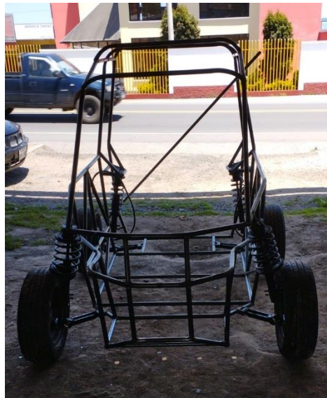
Figura 2.30 Adaptación de sistema de suspensión delantero y posterior
