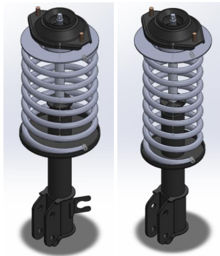
Figura 2.4 Grupo de amortiguadores delanteros RH/LH Chevrolet Spark (i) Grupo de amortiguador delantero Daewoo Matiz (d)
