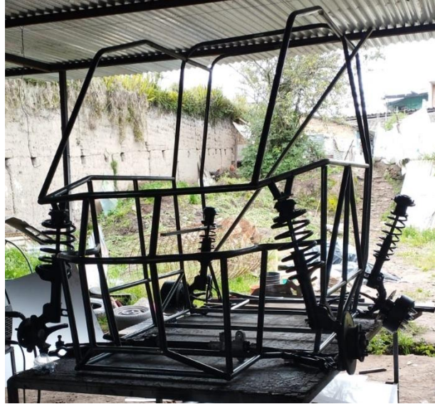
Figura 2.29 Acoplamiento del sistema de suspensión
