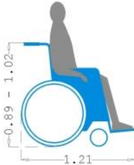
Figura 1.8 Vista lateral de una silla de ruedas y sus medidas generales (Verswyvel, 2009)
