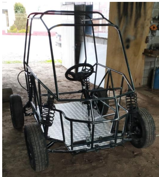
Figura 2.32 Construcción final del chasis
