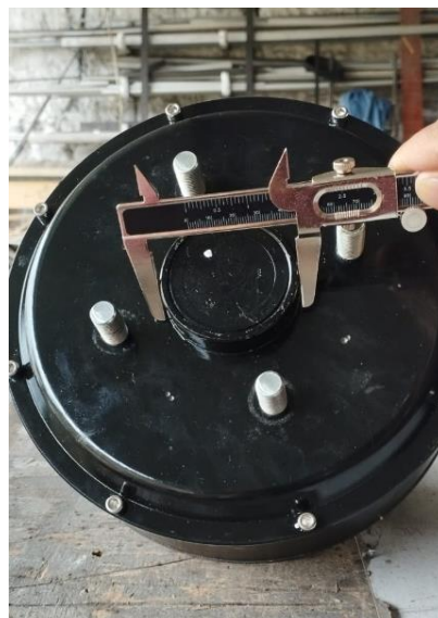
Figura 2.28 Medición de los motores eléctricos para acoplar al bastidor
