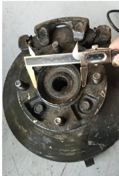
Figura 2.27 Medición de partes de las manzanas para acoplar al bastidor
