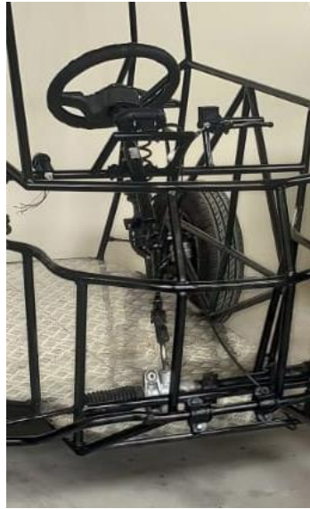
Figura 2.31 Adaptación de sistema de dirección
