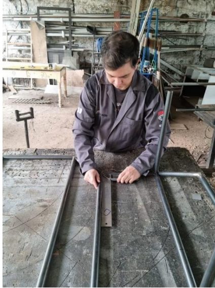
Figura 2.22 Verificación de ángulos rectos con escuadra
