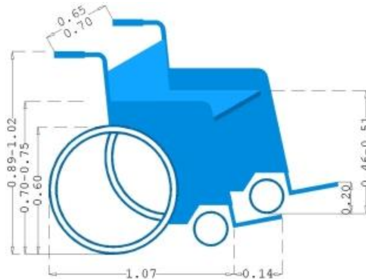
Figura 1.6 Vista isométrica de una silla de ruedas y sus medidas generales (Verswyvel, 2009)
