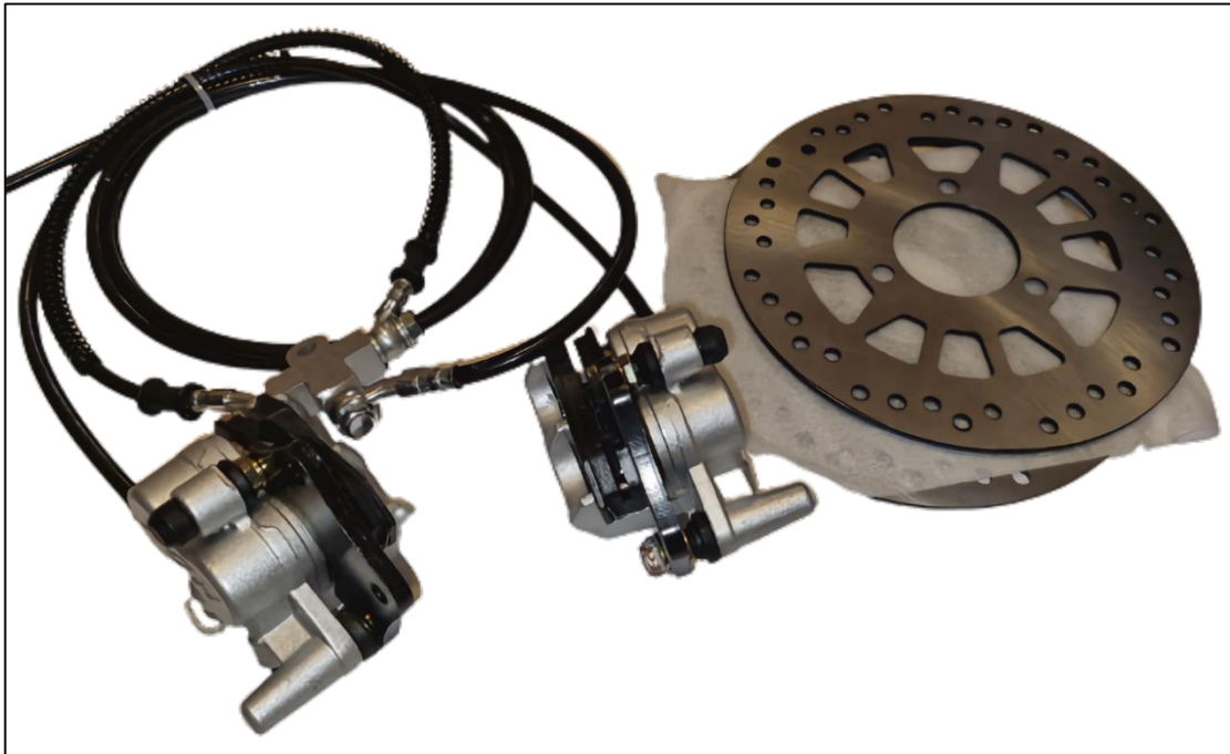
Figura I.6 Sistema de dos unidades de freno de disco posterior
