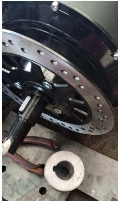
Figura IV.4 Fabricación de bujes de aluminio y adaptación de los motores eléctricos a la suspensión posterior
