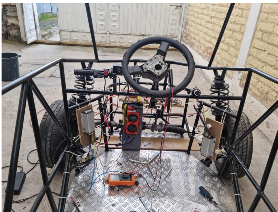
Figura IV.8 Cableado eléctrico y ubicación de la batería de tracción
