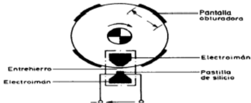
Figura 1.3 Sensor CMP tipo Hall (Rodrigo, 2015)
