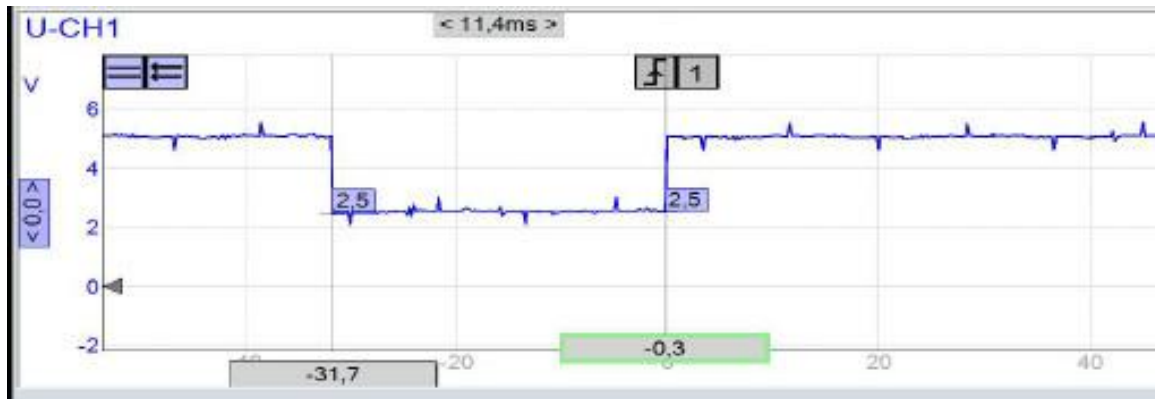
Figura 3.25 Oscilograma sensor CMP falla 1
