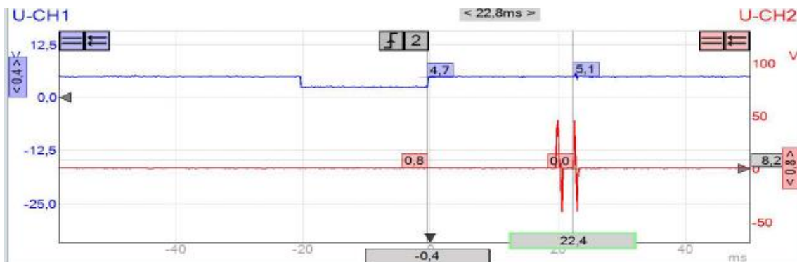
Figura 3.27 Oscilograma sensor CMP falla 4 y señal inyector 1
