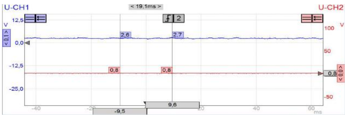
Figura 3.13 Oscilograma sensor CKP falla e inyector del cilindro 1
