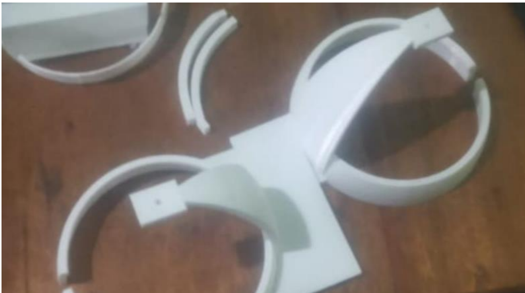
Figura 62: Estructura del sujetador Impresa en material ABS
