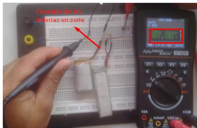
Figura 72: Voltaje generado por las Baterías
