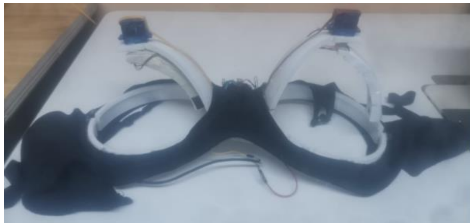
Figura 67: Acoplamiento de la estructura al brasier
