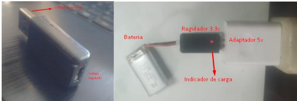
Figura 73: Test visual de la carga de la batería
