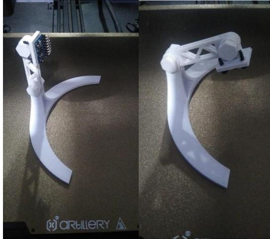
*Figura 4.6 Soporte para el sensor MPU – 6050.*
