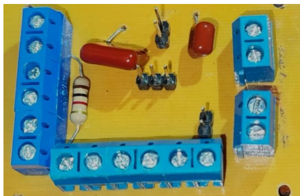
Figura 3.33. Fabricación de la PCB, elementos soldados en la PCB.
