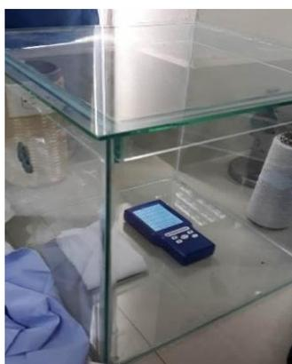
Para medir con exactitud la ppm de cada muestra a analizar se deberá colocar en una cámara de 30x30 cm que se encuentre totalmente fuera de contaminación para que así sean introducidas las probetas y así ser analizadas con exactitud obteniendo datos certeros.
