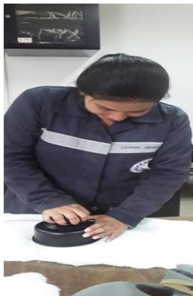
A continuación, se debe pesar cada una de las muestras individualmente en la balanza digital como se muestra en la **Figura 21** para que posteriormente se logre sacar el promedio y multiplicar por 100, el resultado obtenido es el gramaje en  $\text{g/m}^2$ .
