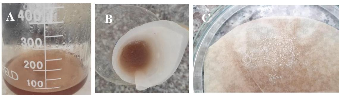
**Figura 17.** *Cristalización A) agua evaporada 80 % B) Filtrado de cristales C) Cristales de ácido cítrico*
