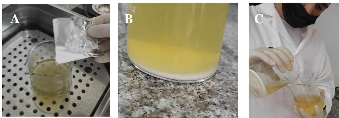
**Figura 16.** Separación A) Adición de hidróxido de calcio B) Citrato cálcico (blanco) y fase líquida C) separación
